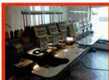
Stickmaschine der Marke SWF Bestickt 6 Textilien gleichzeitig oder 2 verschiedene Aufträge auf jeweils 3 Köpfen
